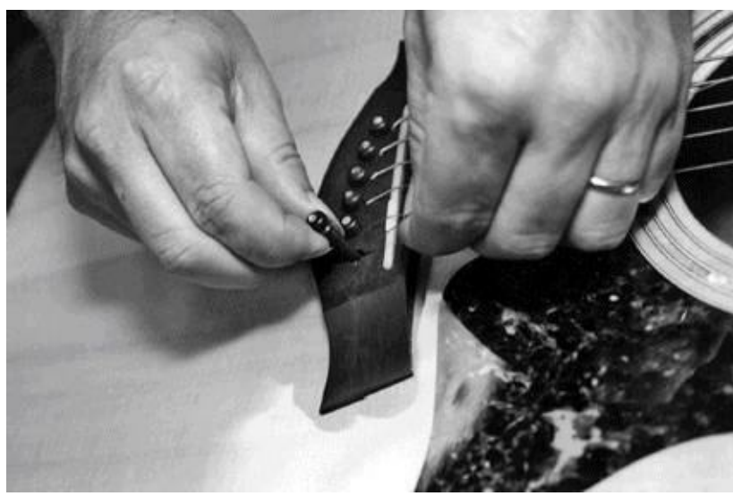
Figura 17-1: Cómo colocar la cuerda nueva en el puente y fijar el pivote del puente
