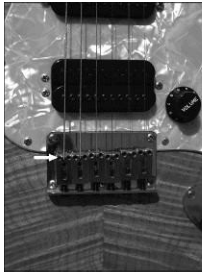
Figura 18-1: Gire los tornillos hexagonales de la selleta del puente para hacer subir o bajar la acción
