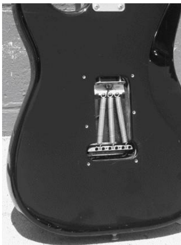
Figura 18-2: Los muelles del puente, en la cavidad trasera de la guitarra
