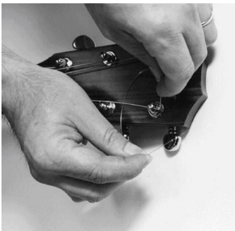
Figura 17-2: Cuerda doblada hacia el interior del clavijero, con holgura suficiente para enrollarla
